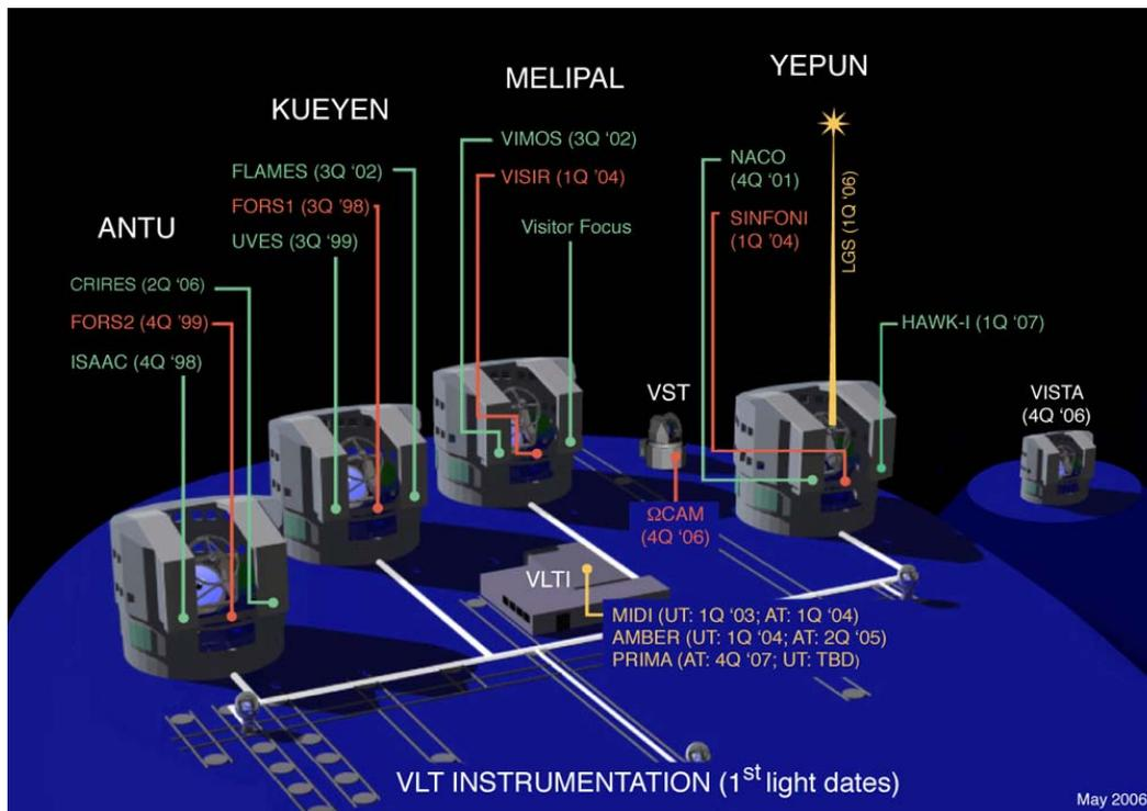
L'instrumentation des VLT est très variée. Le schéma ci-contre les détaille.
