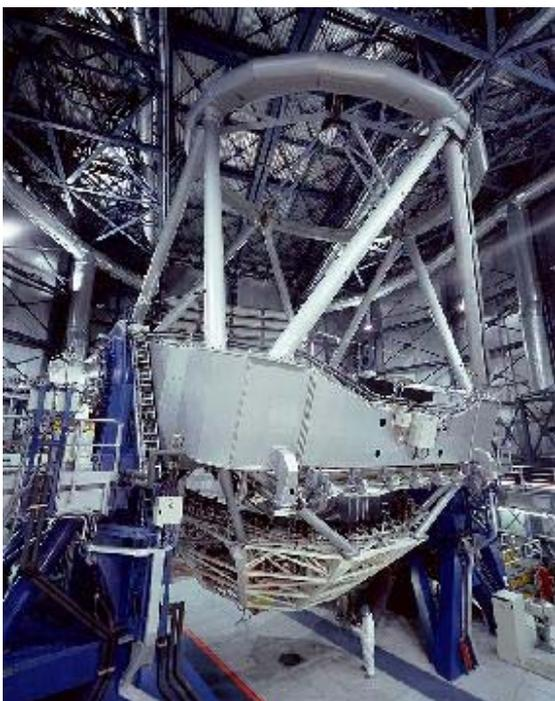
Chaque UT est équipé de 3 foyers principaux (un cassegrain et deux Nasmyth). Le foyer Cassegrain nécessite des instruments légers tournant avec le Telescope, ce qui n'est pas le cas des foyers Nasmyth (le miroir tertiaire M3 est tournant). Un quatrième foyer, dit « foyer coudé » renvoie la lumière sous le Telescope vers d'autres bâtiments et sert en interférométrie.
