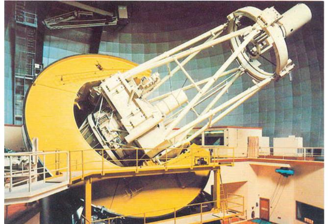
Sa monture équatoriale en fer à cheval en fait le plus grand télescope de ce type (abandonné). Il est aujourd'hui équipé de l'optique adaptative.
